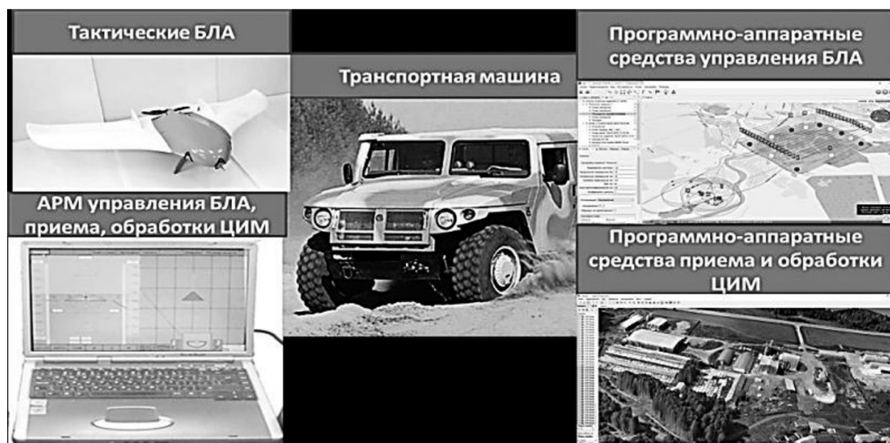
Рис. 1. Состав МК с легким БЛА малого радиуса действия «Грифон»
