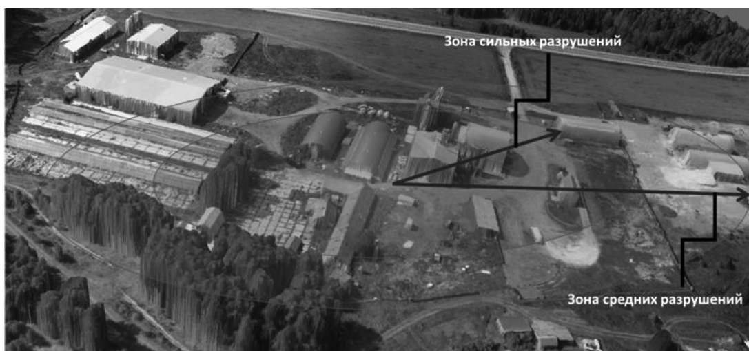
Рис. 2. Зоны сильных и средних разрушений при взрыве на ОЭП
