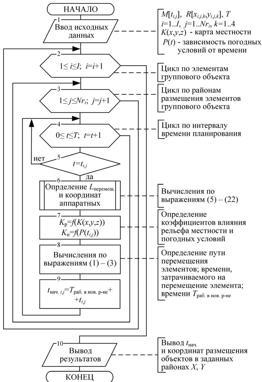
Рис. 3. Алгоритм определения перемещений группового объекта
