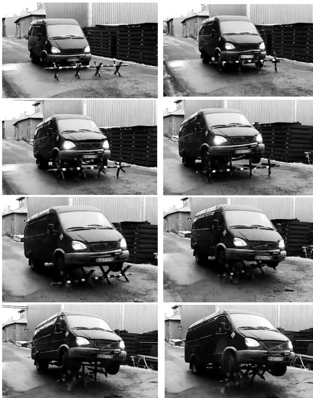
Рис. 13. Кинограмма испытаний образца заграждения «Кактус-400»
