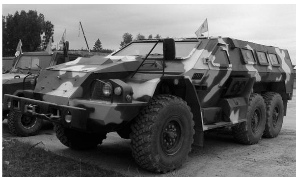
Рис. 11. Специальный бронированный автомобиль СБА-60-К2 «Булат» на узлах и агрегатах КАМАЗ-5350 (фотография с официального сайта «Военное обозрение» <https://topwar.ru>)
