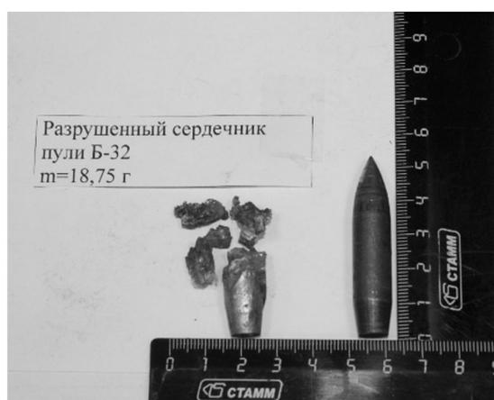
Рис. 7. Разрушенный сердечник пули Б-32 после обстрела образца с керамическим слоем толщиной 12 мм
