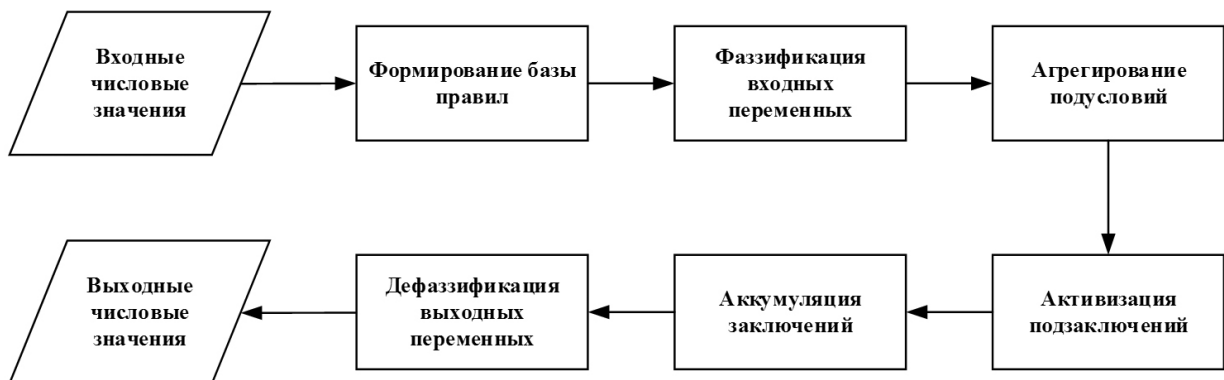
Рис. 1. Схема процесса нечеткого логического вывода по алгоритму Мамдани
