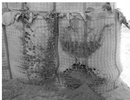
Рис. 4. Результат проведения эксперимента при подрыве 152-мм снаряда ОФ-25 (эквивалент заряд ВВ ТНТ 9 кг)
