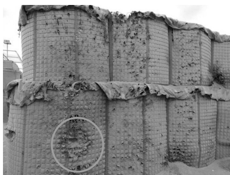
Рис. 6. Результат проведения эксперимента при обстреле ГНТ из ручного противотанкового гранатомета РППГ-7В
