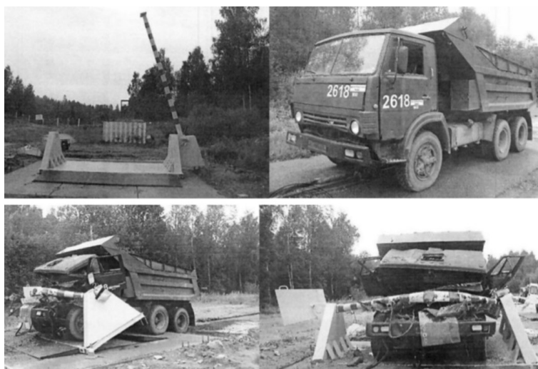
Рис. 8. Действие противотаранного устройства «Трек» [9]
