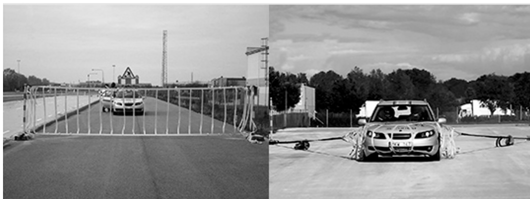
Рис. 4. Ремни для остановки автомобиля [7]
