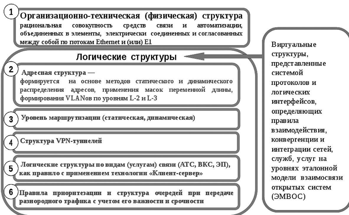
Рис. 1. Архитектура современной телекоммуникационной сети системы связи объединения
