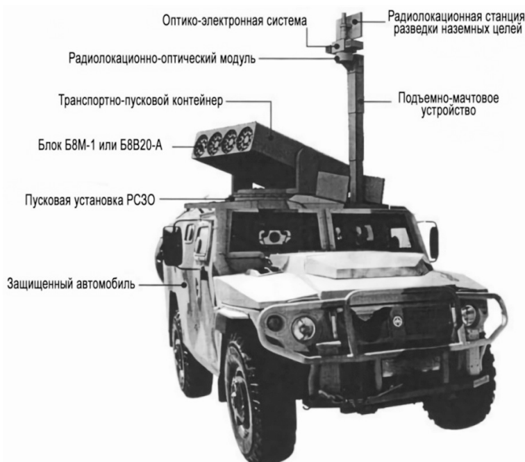
Рис. 4. Боевая разведывательно-ударная машина (полезная модель RU 185 766 U1)
