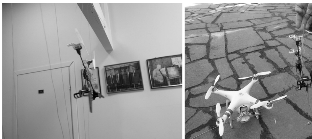
Рис. 6. Захват БПЛА-нарушителя с применением кевларовых нитей
