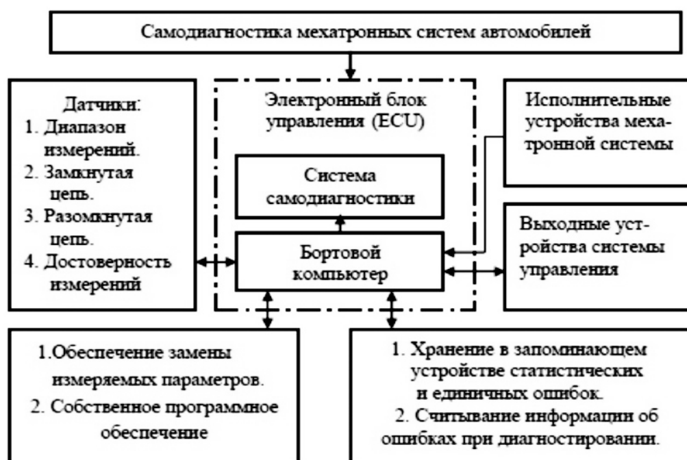
Рис. 3. Структурная схема ECU автомобильной техники
