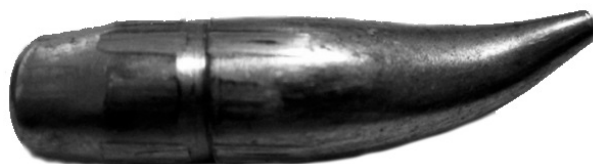
Рис. 8. Травмированная пуля нитью сверхмодульного волокна
