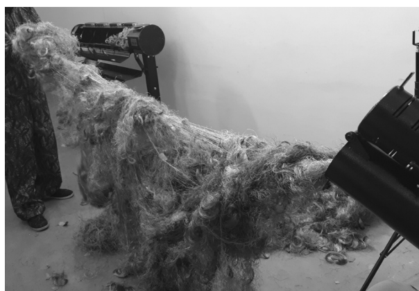
Рис. 7. Извлечение сверхмодульного волокна из тормозного блока
