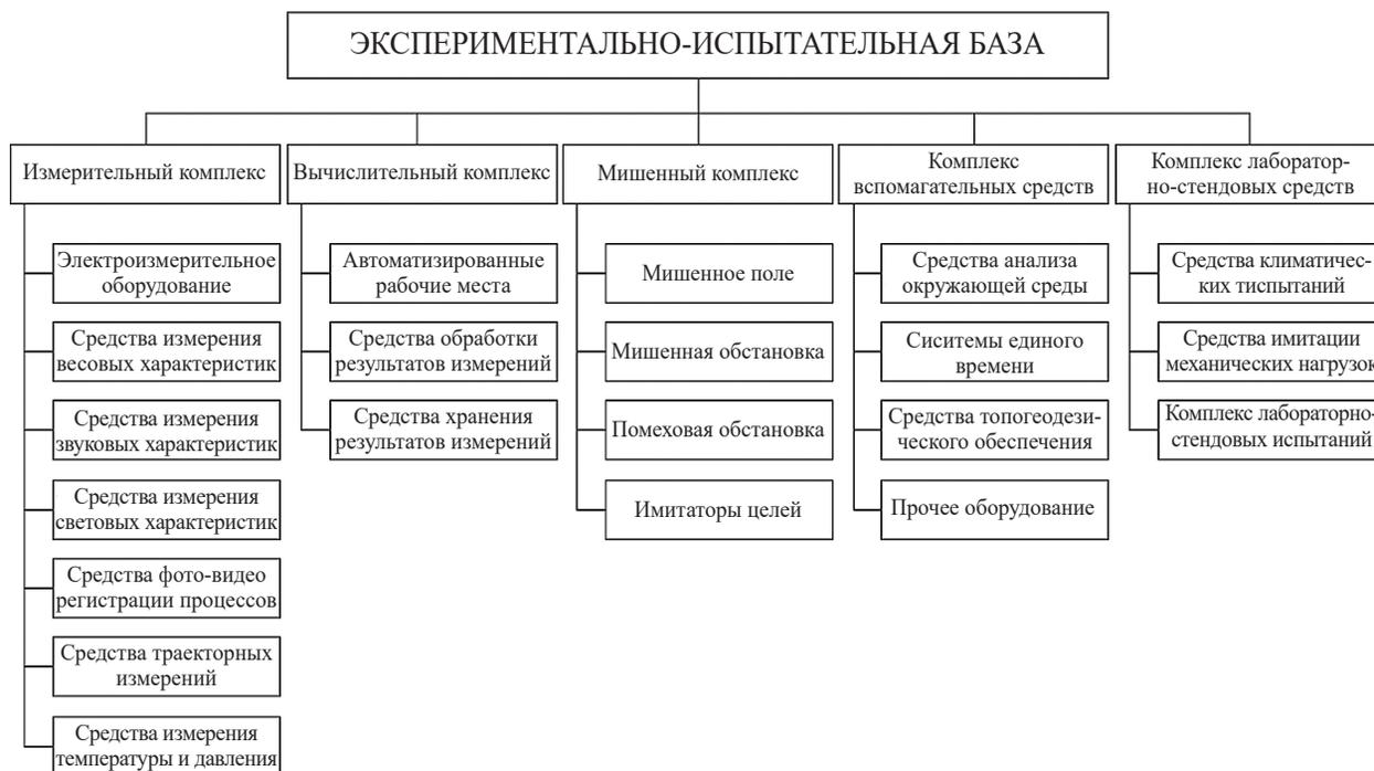
Рис. 1. Типовой вариант состава экспериментально-испытательной базы полигона
